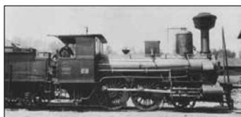
Die erste Lokomotive auf der Westbahnstrecke zwischen Wien und Salzburg – Modell Krenns – wurde 1858 in der Lokomotivfabrik der k.k. Staats-Eisenbahn-Gesellschaft in Wiener Neustadt hergestellt. Sie war 8,40 m lang und hatte größere Räder als die auf der Südbahn eingesetzten Lokomotiven. Der Durchmesser der Treibräder betrug 1,58 m. Sie verließ am 1. August 1860 Wien um 7:00 Uhr und erreichte Salzburg
