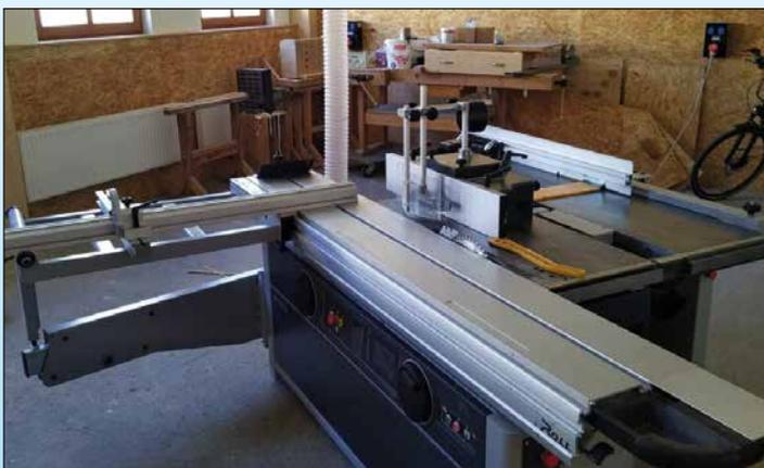
Neue kombinierte Holzbearbeitungsmaschine im Bauhof
