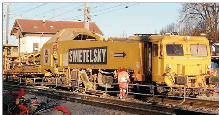
**Links: Begegnung in Neumarkt: Railjet trifft Westbahn Plus. Bild rechts: Im November 2020 war im Bereich des Bahnhofs Neumarkt am Wallersee das „gelbe Monster“, die 153 m lange Gleisbaumaschine SUZ 500 im Einsatz. Diese gewaltige Maschine ersetzt in Fließbandtechnik automatisch die Schwellen, sortiert den Gleisschotter und platziert die Schienen auf den neuen Schwellen.**
